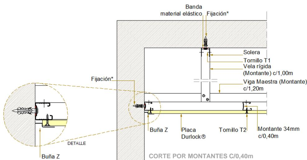
• Se utilizarán tarugos de nylon con tope N° 8 y tornillos de acero de 6mm de diámetro x 40mm, o brocas metálicas. La fijación a la losa se realizará con dos tarugos o brocas.
