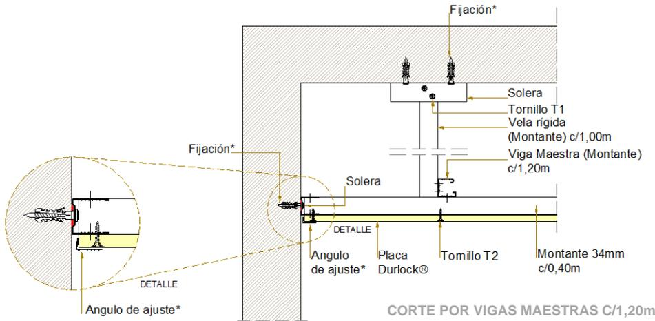
•Se utilizarán tarugos de nylon con tope N° 8 y tornillos de acero de 6mm de diámetro x 40mm, o brocas metálicas. La fijación a la losa se realizará con dos tarugos o brocas.
