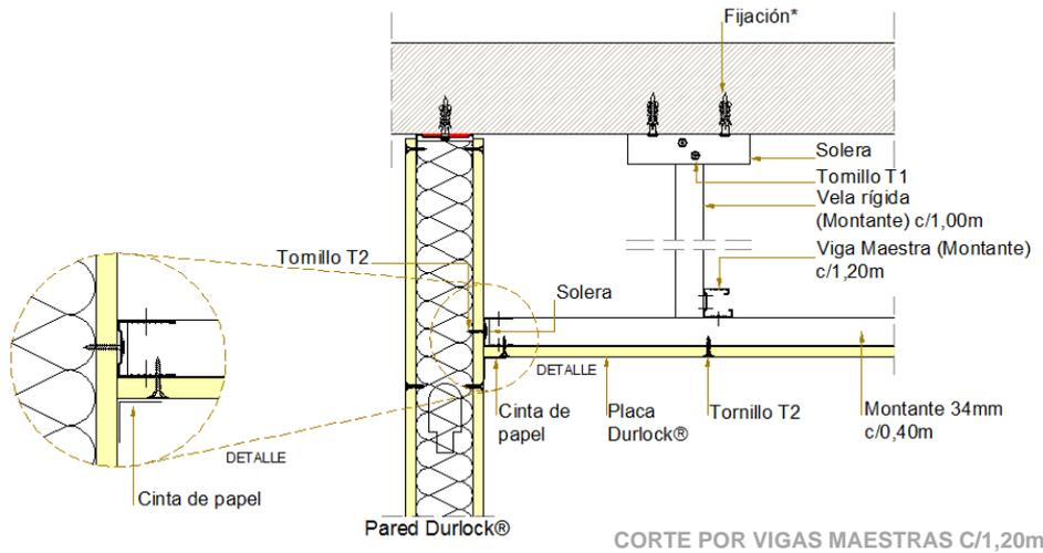
•Evitar puentes acústicos a través de cielorrasos construyendo las paredes hasta la losa.
