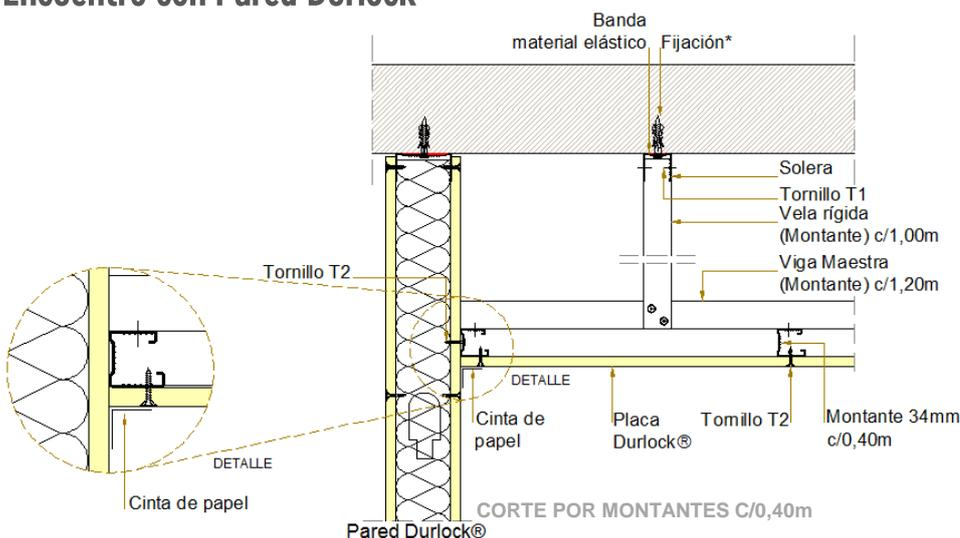
• Evitar puentes acústicos a través de cielorrasos construyendo las paredes hasta la losa.
