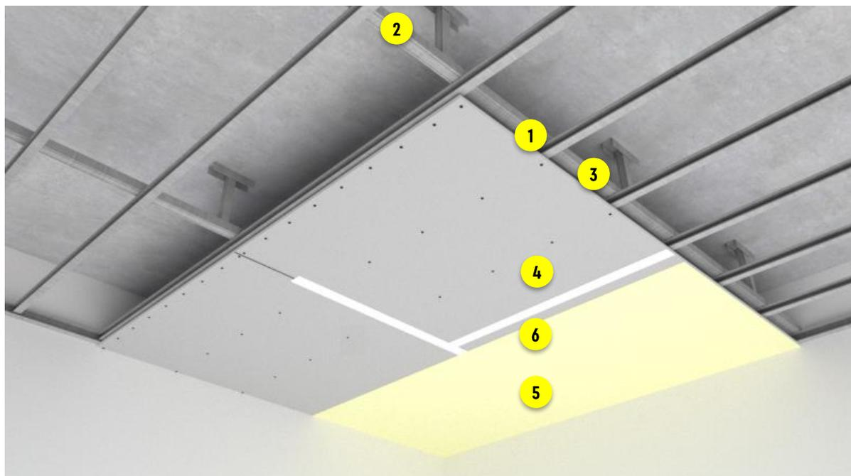
Cielorraso interior, compuesto por una estructura metálica de 35mm, a la cual se atornilla una capa de placas Durlock®. **Los cielorrasos Durlock® no son transitables.**
