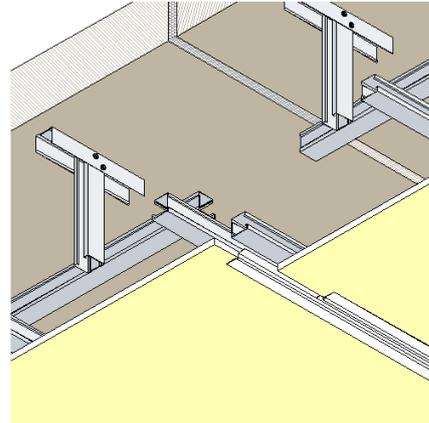
En grandes superficies se deben generar juntas de trabajo que definan módulos independientes, Tanto la continuidad de la superficie del cielorraso como su estructura deberán ser interrumpidas mediante estas juntas ubicadas con una distancia máxima de 10m en cualquier dirección, o en coincidencia con las juntas de dilatación del edificio. La terminación de la junta se realiza con dos perfiles de terminación Buña Z.
